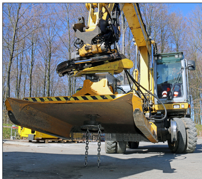
Mandskabet hos Lokaltog A/S bruger det svære gods til klipping af krat og bevoksning langs de fem banestrækninger. En 13 millimeter kæde med ekstra led i kassetten.
