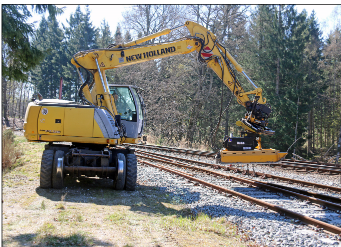
Skinmaskinen med IIsbo H1500E-klipperen bruger kun skinnehjulene uden for togtiderne.
