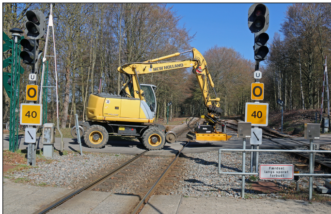
Ekvipagen bestående af en New Holland-gravemaskine med Engcon-tiltrotator og IIsbo-kædeklipper på vej i skoven. Der skal klippes langs sporene.
